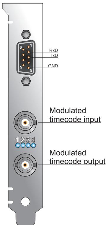
In der Slotabdeckung der Karte sind die Anschlussbuchsen für die amplitudenmodulierten Zeitcodes, vier Leuchtdioden sowie ein 9-poliger D-SUB-Stecker herausgeführt.
