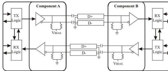
Eine einzelne Lane ist damit vollduplexfähig und wird mit 2.5 GHz getaktet. Daraus resultiert ein Datentransfer-volumen von 250 MB/s pro Lane gleichzeitig in jede Richtung. Höhere Bandbreiten werden realisiert durch die gleichzeitige Verwendung mehrerer Lanes. So nutzt z.B. ein PCIe x16 Steckplatz sechzehn Lanes und erreicht damit ein maximales Transfervolumen von 4 GB/s. Zum Vergleich: PCI erlaubt 133 MB/s und PCI-X 1 GB/s jedoch alles jeweils nur in eine Richtung.
