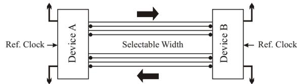
Die Datenübertragung innerhalb des Links erfolgt über Lanes, wobei jede Lane wiederum aus einem Adernpaar für das Senden und einem Adernpaar für das Empfangen von Daten besteht:
