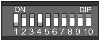
Abbildung: DIP-Schalter auf der RSC180
