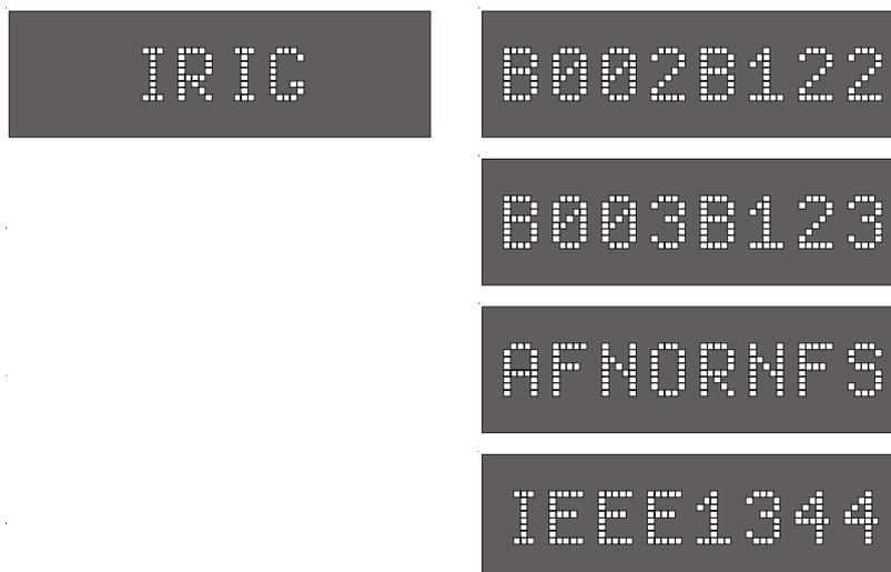
Die PZF600 verfügt neben dem amplitudenmodulierten Sinuskanal auch über einen unmodulierten TTL Ausgang zur Ausgabe des pulsweitenmodulierten DC-Signals, so dass sechs unterschiedliche Zeitcodes verfügbar sind (siehe auch Kapitel *Timecode*):
