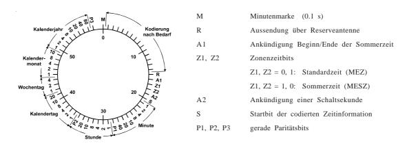
Sekundenmarken mit einer Dauer von 0.1 sec entsprechen einer binären "0" und solche mit 0.2 sec einer binären "1". Die Information über die Uhrzeit und das Datum sowie einige Parity- und Statusbits finden sich in den Sekundenmarken 17 bis 58 jeder Minute. Durch das Fehlen der 59. Sekundenmarke wird die Minutenmarke angekündigt. Die Zeitmarken sind mit TTL-Pegel (aktiv HIGH) an der Steckerleiste verfügbar.
