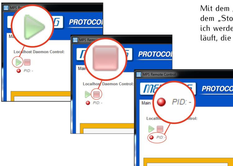
Mit dem „Play“ Button kann der Dienst gestartet, mit dem „Stop“ Button gestoppt werden. Im „PID“ Bereich werden der aktuelle Status und, sofern der Dienst läuft, die Prozess-ID angezeigt.
