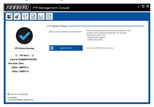
Über die Programmeinstellungen lässt sich konfigurieren, ob das Programm beim Systemstart automatisch gestartet und in den System Tray minimiert werden soll. Die folgende Abbildung zeigt das entsprechende Icon.
