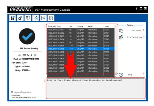
Die Darstellung der Ereignisse in dem Programm erfolgt in zwei Schritten. Nach einem Klick auf den Button "Load Events" (Nummer 3 in der Abbildung) wird eine Übersicht aller dienstbezogenen Ereignisse in tabellarischer Anordnung erzeugt (Nummer 1 in der Abbildung). Wird ein einzelnes Ereignis nun ausgewählt, werden die Details in der entsprechenden Textbox am unteren Ende der grafischen Oberfläche geladen (Nummer 2 in der Abbildung).
