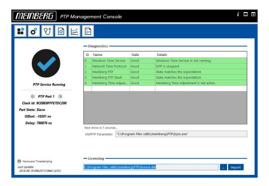
Der Bereich "Diagnostics" ist tabellarisch aufgebaut. Jede ID indiziert einen einzelnen Checkpunkt. Der Zustand der einzelnen Checkpunkte wird durch die Signalfarben Grün ( $\rightarrow$  OK!) und Rot ( $\rightarrow$  Fehler) dargestellt. In der "Details-Spalte" bekommen Sie eine kurze Beschreibung über den Zustand. Die Beschreibung variiert je nach Zustand der Checkpunkte.
