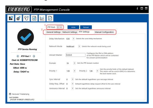
Das Menü "PTP Konfiguration" gibt Ihnen die Möglichkeit, die angelegten PTP Ports zu konfigurieren und die Konfiguration abzuspeichern. Jeder Port kann separat konfiguriert werden. Der zu konfigurierende PTP Port muss in dem entsprechenden Drop-Down Feld ausgewählt werden (Nummer 1 in der Abbildung).
