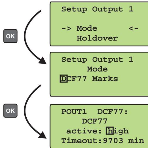
Im Betriebsmodus DCF77 Marks wird der gewählte Ausgang in den DCF77 Simulationsmodus geschaltet, der Ausgang wird im Takt der für den DCF77 Code typischen 100 und 200 ms Impulse (logisch 0/1) aktiviert.
