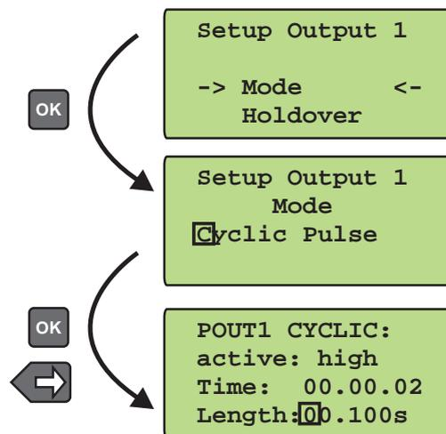
Im Feld **TIME** wird die Zeit zwischen zwei Impulsen eingegeben (im Beispiel 2sek). Diese Zykluszeit muss immer in Stunden, Minuten und Sekunden eingegeben werden.
