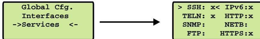
Im Menü werden die möglichen Dienste angezeigt, die der LANTIME zur Verfügung stellt: SSH, TELNET, SNMP, FTP, IPv6, HTTP, HTTPS und NETBIOS. Die einzelnen Dienste können über die Auf/Ab Tasten aktiviert oder deaktiviert werden. Die Navigation durch die Liste erfolgt mit Hilfe der Rechts/Links Tasten. Die Dienste werden direkt nach dem Abspeichern mit OK entsprechend gestartet oder beendet.
