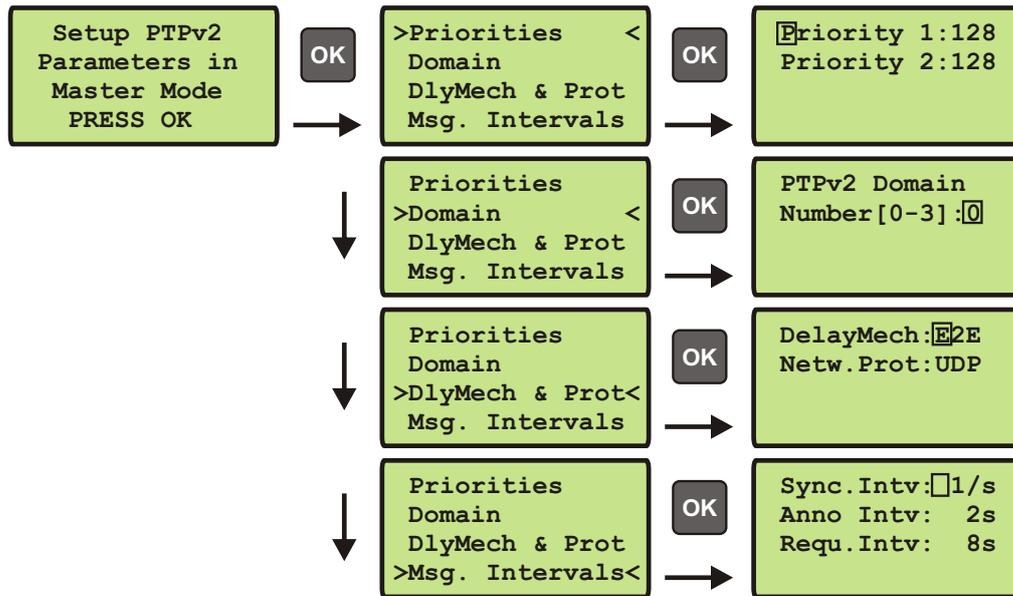
Für den Betrieb im Multicast Master Modus können zusätzlich zu den bereits beschriebenen Parametern aus dem Kapitel PTP Parameters die Paketrage der Sync, Announce und Delay Request Messages eingestellt werden (64/sec...64 sec).
