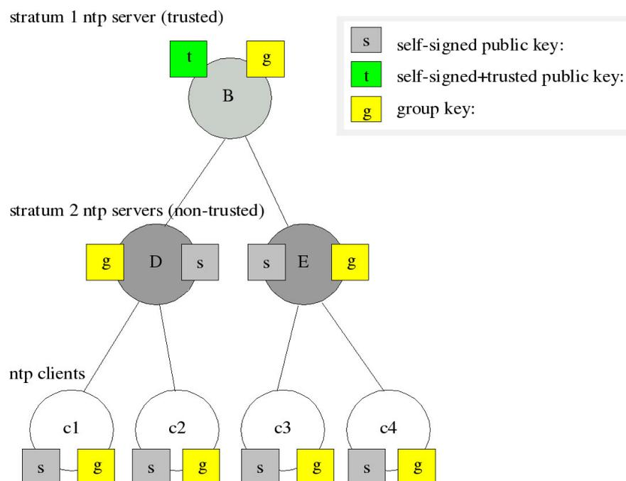
D und E sind NTP Server, die als Hosts der Gruppe nicht Trusted sind. Sie besitzen den Gruppenschlüssel und ein selbstsigniertes Zertifikat (das nicht als „Trusted“ markiert wurde). Die Clients besitzen jeweils den Gruppenschlüssel und ebenfalls ein selbstsigniertes Zertifikat.
