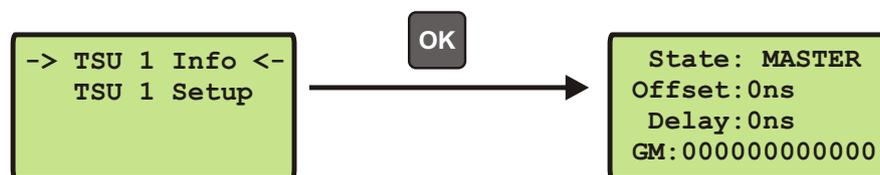
Die Seite „TSU x Info“ vermittelt einen Überblick über den Status der wichtigsten Parameter des PTP Subsystems. Die Zusammenstellung der Parameter ist abhängig vom eingestellten Modus. In der Betriebsart „Grandmaster“ wird hier der „MASTER“ Zustand dargestellt. Die Werte für Offset und Delay sind im Master-Modus auf 0 gesetzt. Darüber hinaus wird die MAC-Adresse des Grandmasters eingeblendet.
