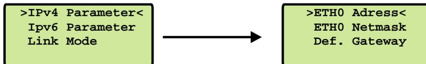
Für jeden physikalischen Netzwerkanschluss (RJ45 Buchse) steht ein separater Abschnitt zur Verfügung. Ist kein DHCP Client Betrieb für IPv4 aktiviert, so kann manuell eine IP-Adresse für den jeweiligen Netzwerkanschluss eingestellt werden. IPv4-Adressen bestehen aus 32 Bit und werden mit 4 dezimalen Werten zwischen 0 bis 255 durch jeweils einen Punkt getrennt eingegeben:
