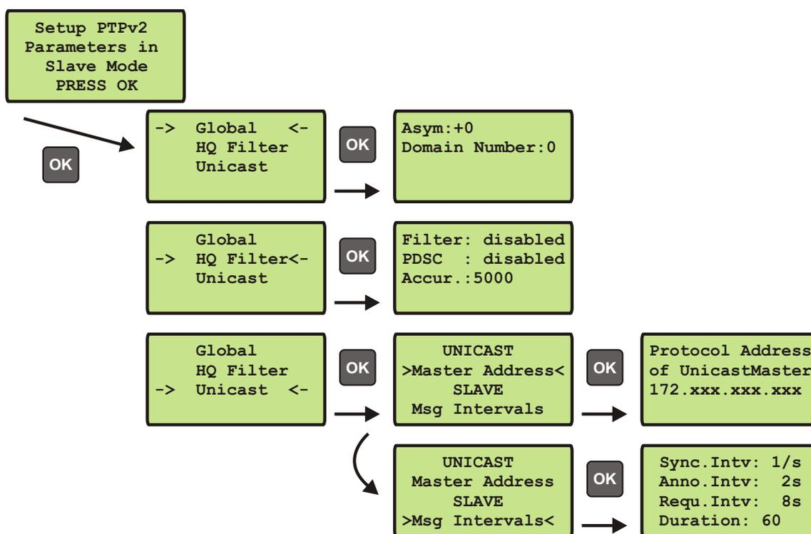
Zusätzlich zu den im Kapitel „PTP Parameters“ beschriebenen Parametern können im „Unicast Slave“ Betrieb die folgenden Parameter eingestellt werden.
