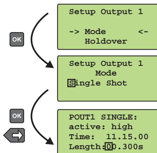
Das Beispiel zeigt einen Einzelimpuls mit 300ms Länge der jeden Tag um 11:15 Uhr erzeugt wird.
