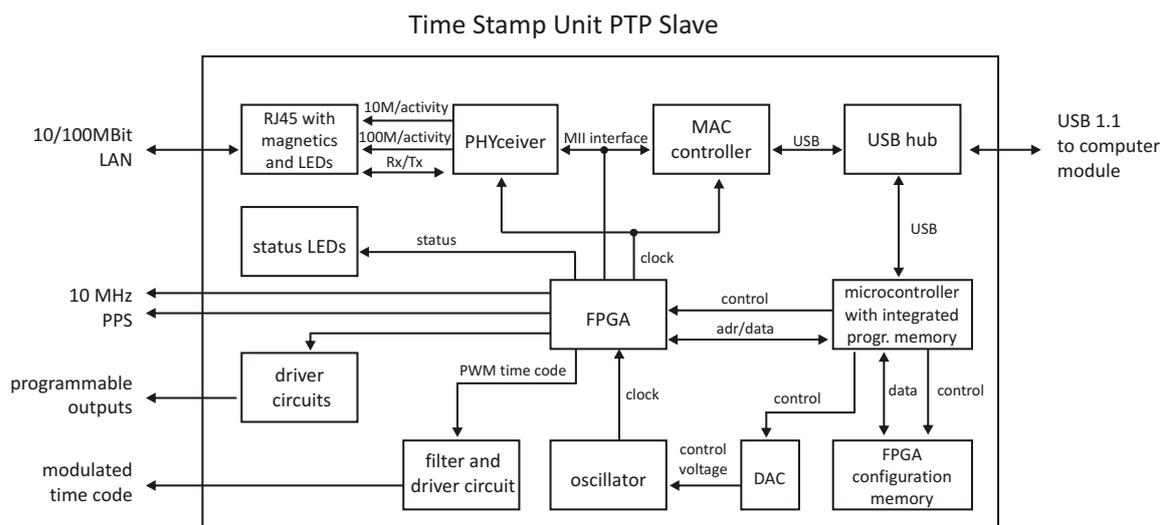
Nach dem Einschalten wartet das System solange, bis eine gültige Zeit von einem PTP Master empfangen wurde und setzt dann seine eigenen PTP Sekunden und Nanosekunden. Der vom PTP Treiber des Computersystems ermittelte PTP Offset wird genutzt, um den Masteroszillator der TSU-USB einzuregeln. Hierdurch wird eine hohe Genauigkeit der vom PTP Slave generierten Ausgangssignale (10 MHz/PPS/IRIG) erreicht, da diese direkt vom Oszillator der TSU-USB abgeleitet werden.
