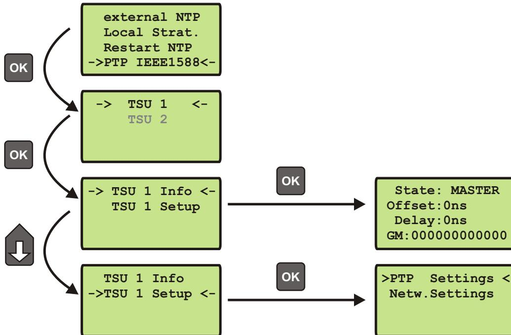
Das Menü für die PTP IEEE 1588 Konfiguration befindet sich unter der Hauptmenükategorie „Time Service“ und ist in die Abschnitte „TSU x Info“ und „TSU x Setup“ unterteilt. In einem Gerät mit mehr als einer PTPv2 Karte (auch TSU, Time Stamp Unit genannt), werden die Untermenüs für alle PTP Karten aufgelistet.
