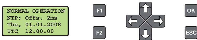
Unten werden das aktuelle Datum, Name der Zeitzone (bei NTP immer UTC; für die seriellen Schnittstellen kann eine andere Zeitzone eingestellt werden) und die aktuelle Zeit angezeigt. Hinter der Uhrzeit kann ein „\*“ erscheinen, wenn die Einstellung „Ignore Lock“ (Simulationsmode) aktiviert wurde.
