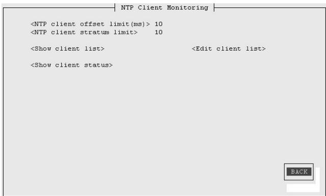
Drei Kriterien liegen der Client Überwachung zu Grunde: Zeit der Abweichung des NTP Clients zum Zeitserver, der Stratum des Clients und die Erreichbarkeit. Trifft eines dieser Bedingungen zu, wird die entsprechend konfigurierte Aktion ausgeführt. Über den Button „Client Status anzeigen“ wird der Status von allen NTP Clients in der Liste angezeigt:
