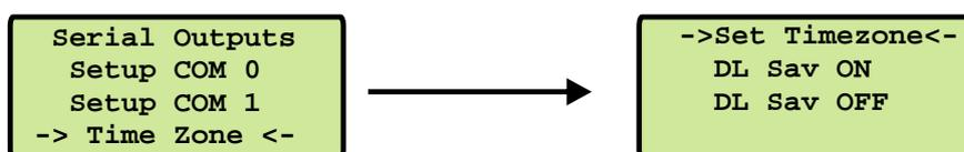
Nach der Auswahl einer von beiden Menüpunkten gelangt man hier zu den Einstellmöglichkeiten der Winter- bzw. Sommerzeit. Exemplarisch wird in der oben angegebenen Abbildung die Konfiguration der Winterzeit aufgezeigt.
