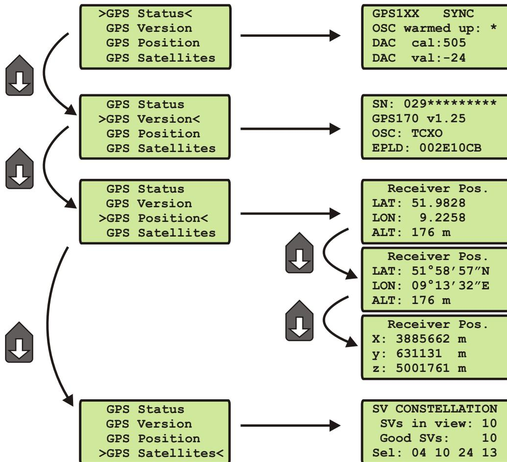
In diesem Menü werden alle wichtigen Informationen zur GPS Funkuhr, des internen Oszillators und der GPS Satelliten angezeigt.
