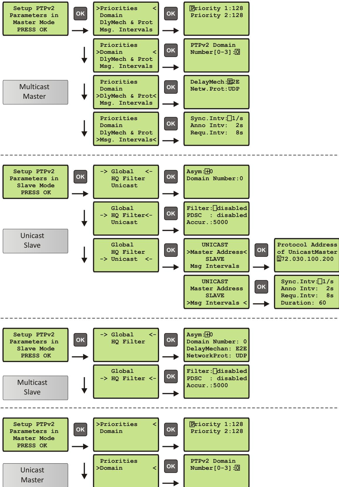
In Abhängigkeit vom eingestellten PTP Mode werden im Untermenü „PTP Parameters“ verschiedene Untermenüs dargestellt.
