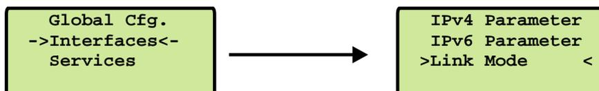
Über das Link Mode Untermenü können die Parameter für Geschwindigkeit und Duplex der ersten Netzwerkschnittstelle eingestellt werden. Es stehen 5 Modi zur Verfügung: Autosensing, 10 MBit/Halb-Duplex, 100 MBit/Halb-Duplex, 10MBit/Voll-Duplex, 100 MBit/Voll-Duplex. Standardmäßig werden die Schnittstellen auf Autosensing eingestellt.
