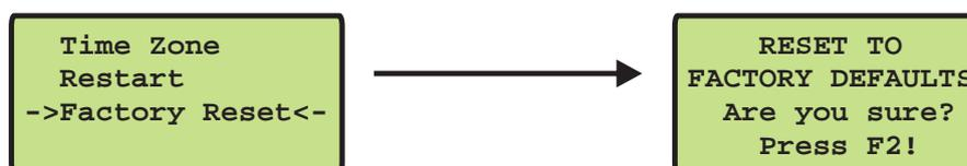
Wird der Menüpunkt **Reset to Factory Defaults** aufgerufen und bestätigt, werden alle Netzwerk Parameter und Systemparameter auf die Werkseinstellung zurückgesetzt.
