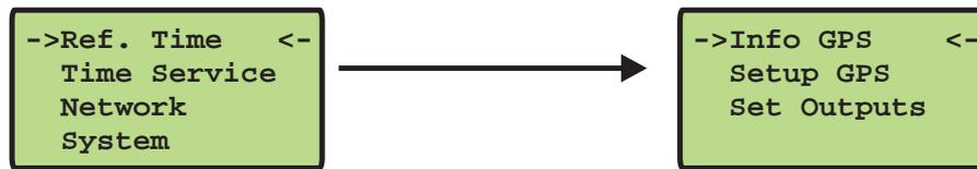
Mit der „OK“ oder Pfeil-Rechts Taste werden die Untermenüs geöffnet.
