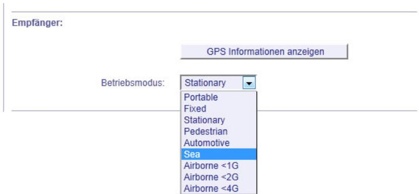
Das Beispiel zeigt das Menü bei einem GPS Empfänger mit MGR Modul. Über den Button „GPS Informationen anzeigen“ wird ein Textfeld mit allen relevanten Informationen des Empfängers geöffnet. Bei dem LANTIME mit GPS Empfänger und MGR Modul kann noch der Betriebsmodus auf die entsprechende Umgebung eingestellt werden. Damit wird sichergestellt, dass der Empfänger in Abhängigkeit von der zur erwartenden Geschwindigkeit seine Position berechnet.
