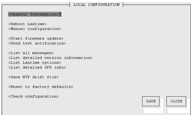
Im nächsten Abschnitt werden verschiedene Funktionen für den Administrator zur Verfügung gestellt. Über den Punkt „Reboot LANTIME“ wird ein Shutdown auf dem System ausgeführt. Das System braucht ca. eine halbe Minute für den Bootvorgang. Die Referenzuhr bekommt damit keinen RESET.
