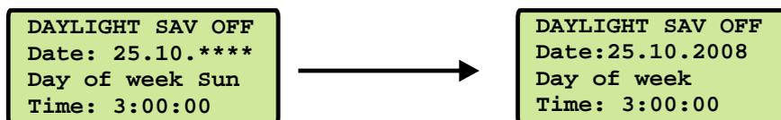
Für den Fall, dass keine Sommerzeitumstellung benötigt wird, sind unter beiden Menüpunkten (DAYlight SAVING ON / OFF) beliebige aber exakt gleiche Daten, Zeiten und Offsets zu setzen. Nach Eingabe dieser Werte sollte ein Restart des Gerätes erfolgen.
