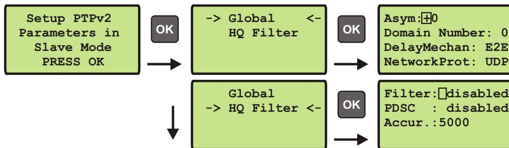
Für den Betrieb im Multicast Slave Modus können zusätzlich zu den bereits beschriebenen Parametern aus dem Kapitel „PTP Parameters“ die Einstellungen für den „HQ Filter“ vorgenommen werden. Die Funktionsweise ist im Kapitel 6.4.11 erläutert.
