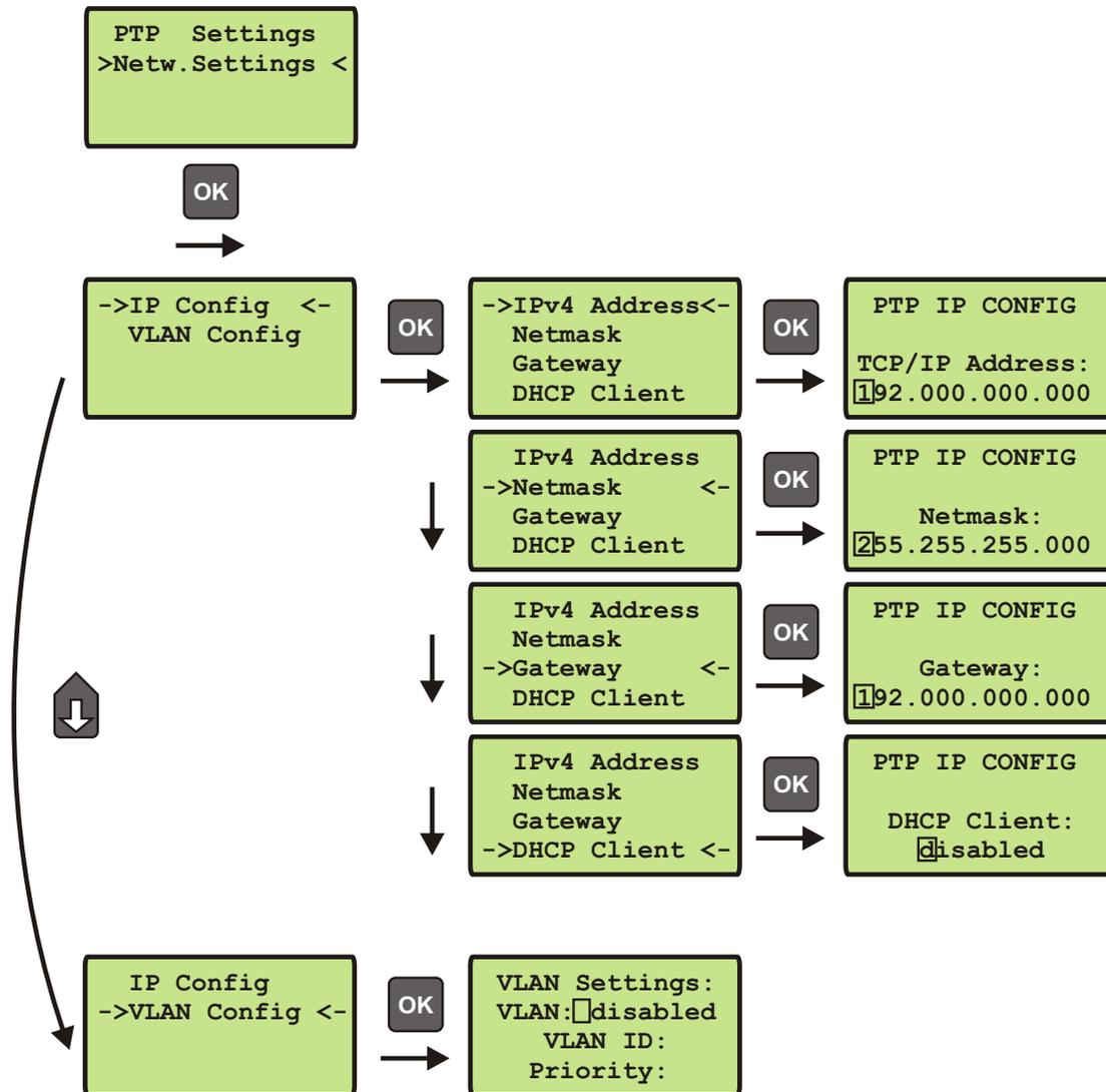
Hier kann die statische IP Konfiguration des PTPx Interfaces vorgenommen werden. Alternativ lässt sich für die PTPx Schnittstelle der DHCP Dienst aktivieren.
