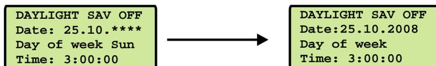
Für den Fall, dass keine Sommerzeitumstellung benötigt wird, sind unter beiden Menüpunkten (DAYlight SAVING ON / OFF) beliebige aber exakt gleiche Daten, Zeiten und Offsets zu setzen.
