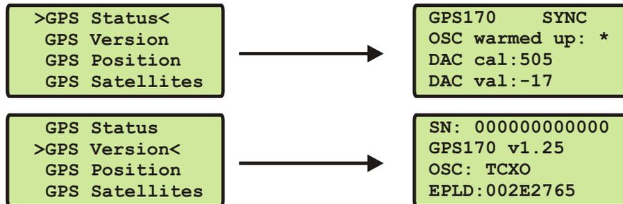
In der ersten Zeile wird der Typ der Referenzuhr (hier GPS) mit dem aktuellen Status der Funkuhr angezeigt. Unter „GPS Version“ werden die Versionsnummer der Firmware, die Seriennummer der Referenzuhr und der eingebaute Typ des Oszillators angezeigt.
