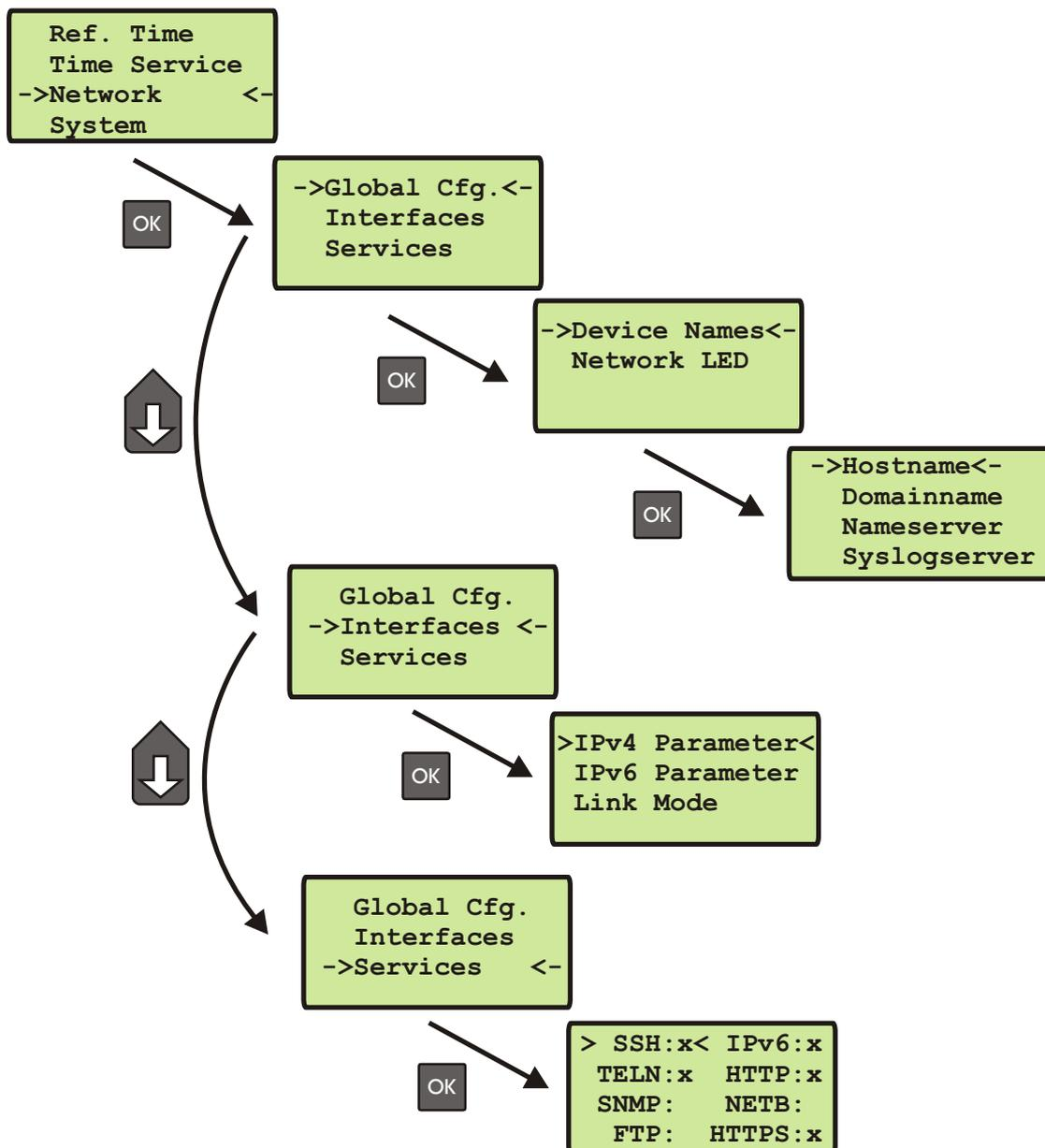
In diesem Untermenü werden die Netzwerkparameter festgelegt. Bei der Erstinstallation des LANTIME müssen diese Parameter an das vorhandene Netzwerk angepasst werden.
