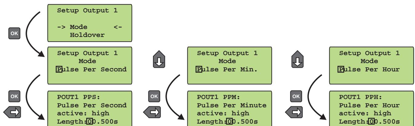
Diese Modi erzeugen Impulse definierter Länge pro Sekunde, pro Minute oder pro Stunde. Im Feld **Length** wird die Impulsdauer in 10ms Schritten zwischen 10ms und 10sek eingestellt.
