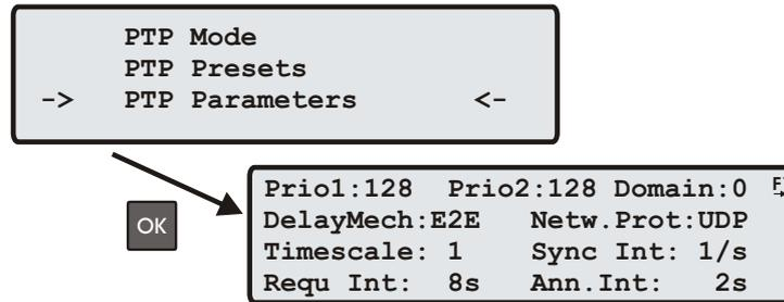
Für den Betrieb im Multicast Master Modus können zusätzlich zu den bereits beschriebenen Parametern aus dem Kapitel Global Parameters die folgenden Einstellungen vorgenommen werden.
