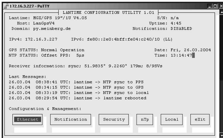
Zum anderen kann über eine TELNET oder SSH Verbindung ein Comand-Line-Interface (CLI) geöffnet werden, wo mit Hilfe des Programms „setup“ eine textbasierte Benutzerschnittstelle gestartet wird. Bis auf wenige Ausnahmen sind das WEB-Interface und das CLI von den Möglichkeiten zur Konfiguration identisch (das CLI hat keine Statistikfunktion).
