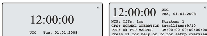
Damit der NTPD sich auf die GPS synchronisieren kann, muss ein ausreichender Empfang der Satelliten gegeben sein, d.h. die „Ref.Time“ LED muss grün leuchten. Ist dies der Fall wird im LC-Display folgende Meldung angezeigt:
