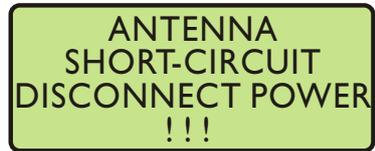
In diesem Fall muss die Uhr ausgeschaltet, der Fehler behoben und danach die Uhr wieder eingeschaltet werden. Die Versorgungsspannung für die Antennen/Konvertereinheit beträgt im Leerlauf ca.18.5V<sub>DC</sub> und bei angeschlossener GPS Antenne ca.16V<sub>DC</sub> .
