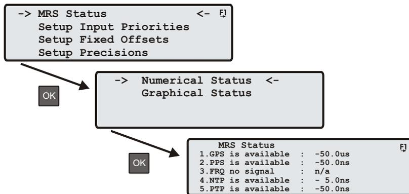
Die Prioritäten für die Referenzuhren, d.h., welche Referenzuhr im Falle eines Ausfalls einer anderen Referenzuhr zur Steuerung des internen Oszillators verwendet werden soll, kann in dem nächsten Untermenü (mit OK oder Pfeil nach rechts) eingestellt werden:
