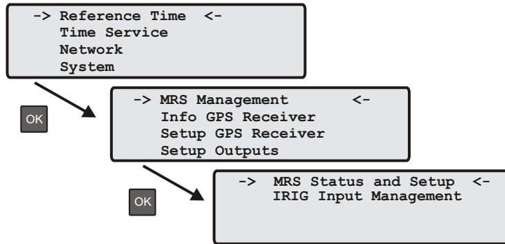
Mittels der „OK“ oder Pfeil nach rechts Taste wird der aktuelle MRS Status angezeigt. Von links nach rechts wird die Reihenfolge der Prioritäten mit den Namen der Referenzzeitquellen, dem Status und dem aktuellen Offset zur internen Zeit des OCXOs und wenn vorhanden den eingestellten festen Offset angezeigt. Der aktuelle Master wird mit einem „\*“ hinter dem Namen oder dem Status markiert.
