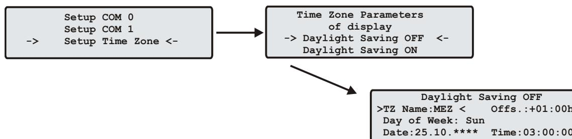
Nach der Auswahl einer von beiden Menüpunkten gelangt man hier zu den Einstellmöglichkeiten der Winter- bzw. Sommerzeit. Exemplarisch wird in der oben angegebenen Abbildung die Konfiguration der Winterzeit aufgezeigt.
