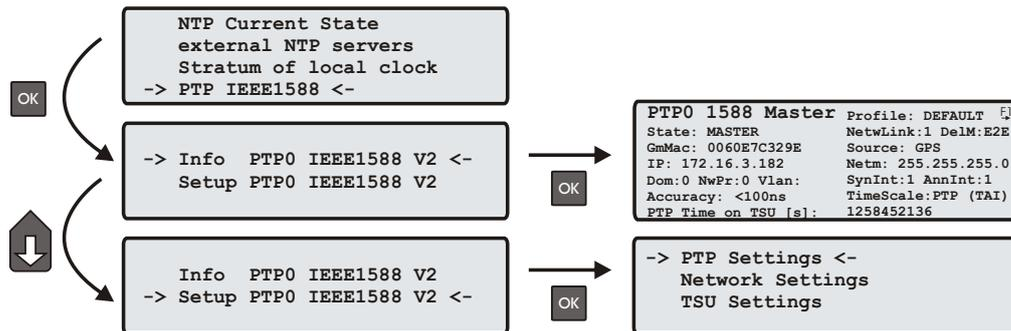
Das Menü für die PTP IEEE 1588 Konfiguration befindet sich unter der Hauptmenükategorie „Time Service“ und ist in die Abschnitte „Info“ and „Setup“ unterteilt.
