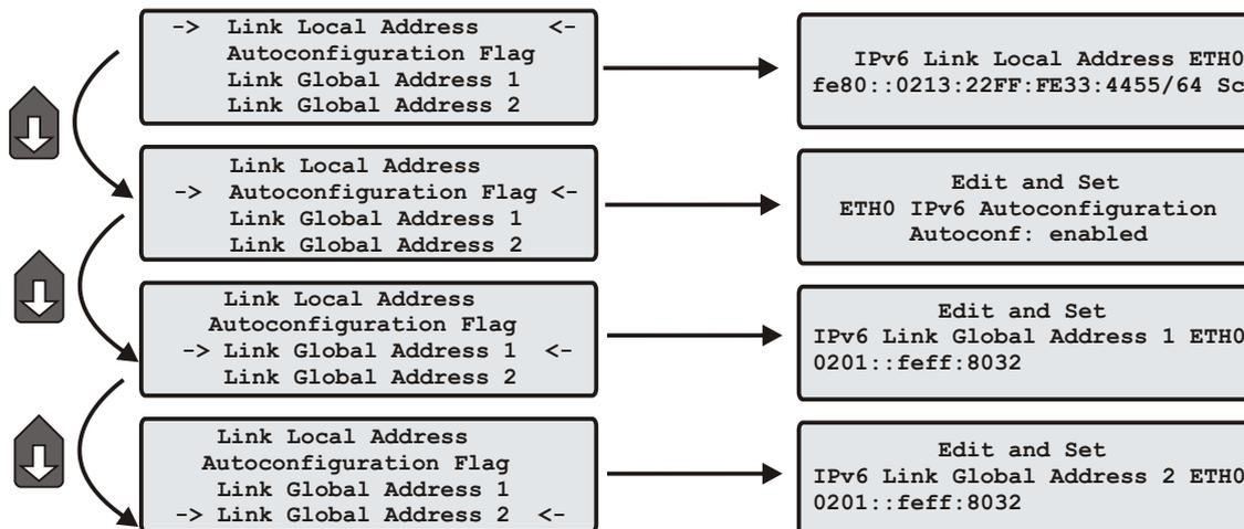
Über das Frontpanel können die Parameter für IPv6 nur für die erste Schnittstelle eingestellt werden. Dabei sind drei globale IPv6 Adressen möglich, zwei davon sind über das Front Panel einstellbar, eine weitere dritte über das WEB-Interface. IPv6-Adressen haben 128 Bits und werden als Kette von 16-bit-Zahlen in Hexadezimal-Notation geschrieben, die durch Doppelpunkte getrennt werden. Folgen von Nullen können einmalig durch „:“ abgekürzt werden.
