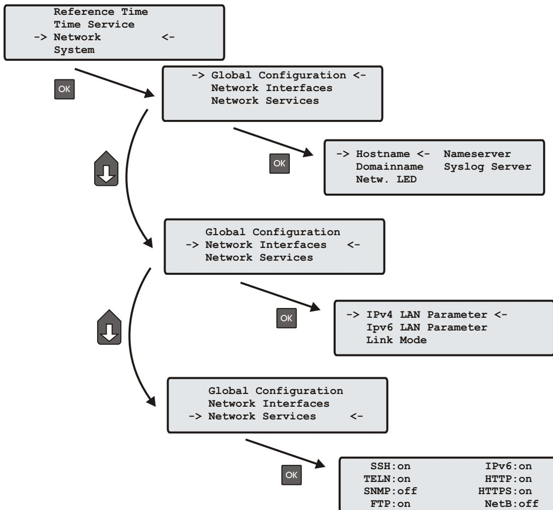
In diesem Untermenü werden die Netzwerkparameter festgelegt. Bei der Erstinstallation des LANTIME müssen diese Parameter an das vorhandene Netzwerk angepasst werden. Es können die folgenden Parameter eingestellt werden:
