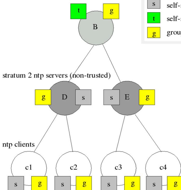
D und E sind NTP Server, die als Hosts der Gruppe nicht Trusted sind. Sie besitzen den Gruppenschlüssel und ein selbstsigniertes Zertifikat (das nicht als „Trusted“ markiert wurde). Die Clients besitzen jeweils den Gruppenschlüssel und ebenfalls ein selbstsigniertes Zertifikat.
