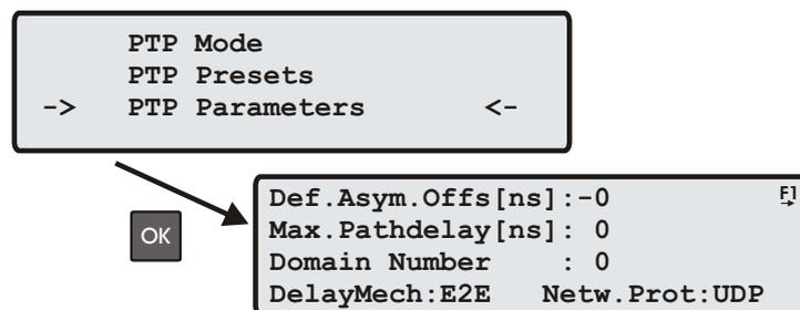
Für den Betrieb im Multicast Slave Modus können zusätzlich zu den bereits beschriebenen Parametern aus dem Kapitel „Global Parameters“ die folgenden Einstellungen vorgenommen werden.
