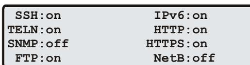
Im Menü werden die möglichen Dienste angezeigt, die der LANTIME zur Verfügung stellt: SSH, TELNET, SNMP, FTP, IPv6, HTTP, HTTPS und NETBIOS. Die einzelnen Dienste können über die Auf/Ab Tasten aktiviert oder deaktiviert werden. Die Navigation durch die Liste erfolgt mit Hilfe der Rechts/Links Tasten. Die Dienste werden direkt nach dem Abspeichern mit OK entsprechend gestartet oder beendet.
