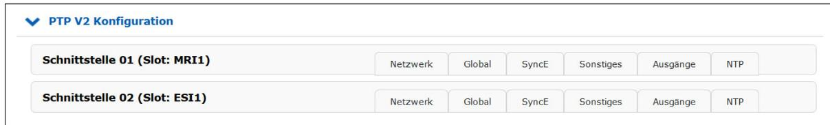
Alle im System verwendeten Parameter für den ordnungsgemäßen Betrieb jedes PTP-Ports (Schnittstelle) sollten entsprechend ihrer Funktion im PTP-Netzwerk separat konfiguriert werden. Wann immer eine Änderung übernommen werden soll, muss sie durch Bestätigen der Schaltfläche „Save Settings“ am Ende der Seite gespeichert werden.
