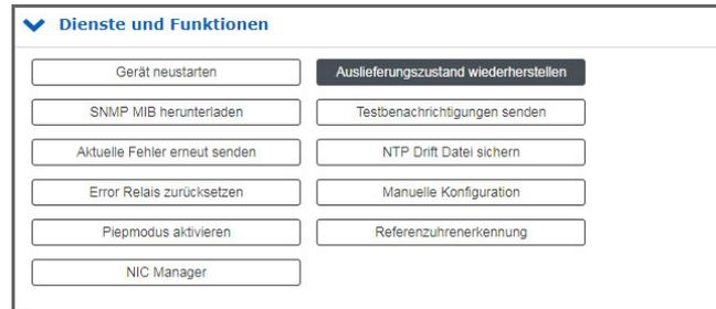
Abbildung 8.27: LANTIME auf Werkseinstellungen zurücksetzen
