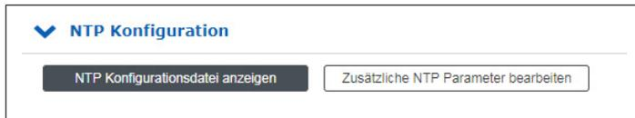
Die aktuelle NTP-Konfigurationsdatei wird über die Schaltfläche „NTP Konfigurationsdatei anzeigen“ angezeigt. Diese Datei wird bei jedem Neustart oder jeder Änderung der NTP-Konfiguration automatisch vom System erzeugt und kann nicht direkt bearbeitet werden.
