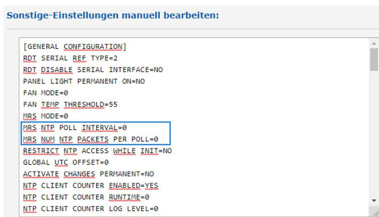
Mit dem Parameter „MRS NTP POLL INTERVAL“ können Sie das Polling-Intervall des externen Servers anpassen. Standardmäßig ist dieser Wert auf 0 gesetzt, d.h. externe Server werden alle 32 Sekunden abgefragt. Die Werte können zwischen 1 und 10 eingestellt werden und werden als Potenz von 2 verwendet, z.B. wenn dieser Wert auf 6 gesetzt wird, entspricht das  $2_6 = 64$  Sekunden für ein Abfrageintervall.
