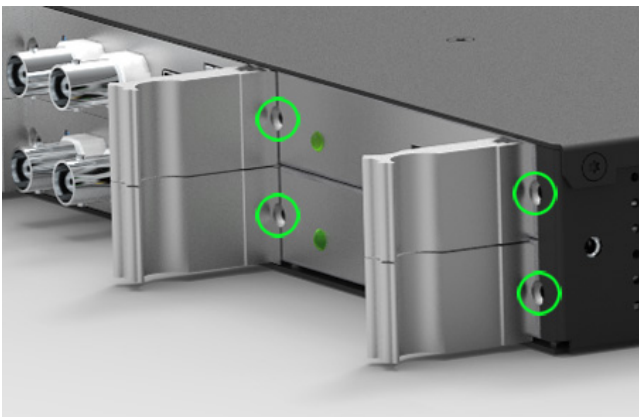
Befestigungspunkte bei einem 1HE IMS System
