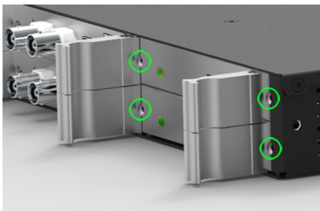
Befestigungspunkte bei einem 1HE IMS System
