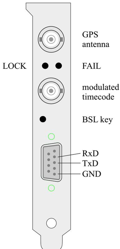
Die Anschlussbuchse für das Antennenkabel sowie zwei LEDs und ein 9-poliger Sub-D-Stecker sind im Rückwandblech eingelassen. Die obere, grüne LED (LOCK) wird eingeschaltet, wenn die Funkuhr nach dem Einschalten mindestens vier Satelliten empfangen und damit ihre Position bestimmt hat. Im Normalfall wird die Empfängerposition laufend überprüft, solange mindestens vier Satelliten empfangen werden können.
