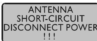
In diesem Fall muß die Uhr ausgeschaltet werden, der Fehler behoben und danach die Uhr wieder eingeschaltet werden. Die Versorgungsspannung für die Antennen / Konvertereinheit beträgt im Leerlauf ca.  $18.5V_{DC}$  und bei angeschlossener GPS Antenne ca.  $16V_{DC}$ .
