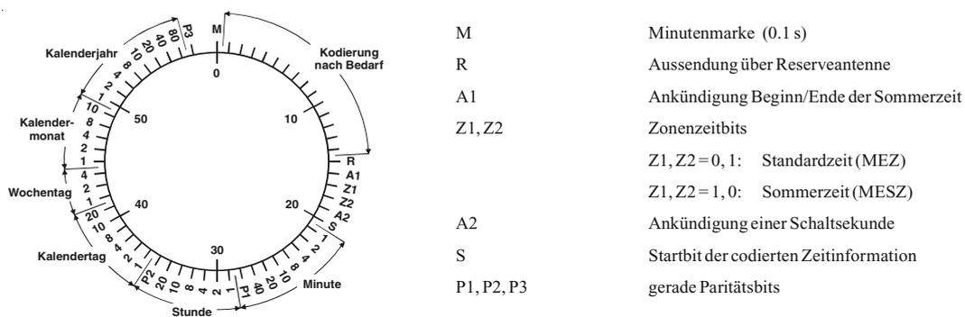
Sekundenmarken mit einer Dauer von 0.1 sec entsprechen einer binären "0" und solche mit 0.2 sec einer binären "1". Die Information über die Uhrzeit und das Datum sowie einige Parity- und Statusbits finden sich in den Sekundenmarken 17 bis 58 jeder Minute. Durch das Fehlen der 59. Sekundenmarke wird die Minutenmarke angekündigt. Die Zeitmarken sind mit TTL-Pegel (aktiv HIGH) an der Steckerleiste verfügbar.
