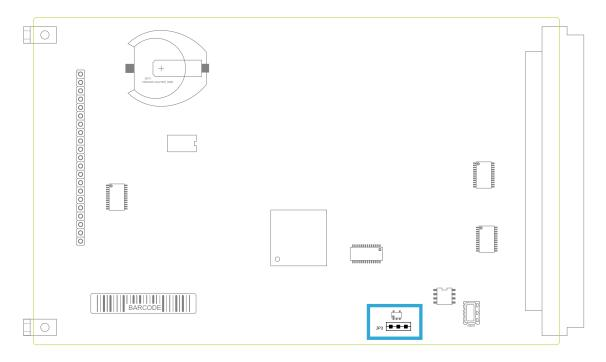
Die unten stehende Abbildung zeigt, wie mit Hilfe der Jumper eingestellt werden kann, ob eine externe 10 MHz-Frequenz oder die 10 MHz des internen Oszillators als Referenzfrequenz verwendet werden.
